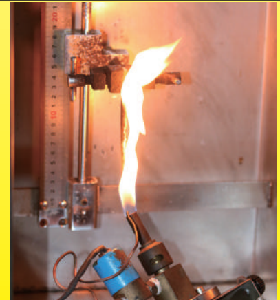
Prüflinge während der Prüfung laut UL94 V-0
