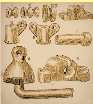
1885 Elektroisolatoren aus Porzellan (La physique moderne: l'électricité dans la maison, E. Hospitalier)
